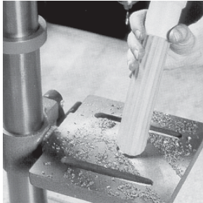
Reinigung von unebenen und rauen Flächen mit der Schrägrohrdüse aus Gummi (Best.-Nr. 58 402 2)
